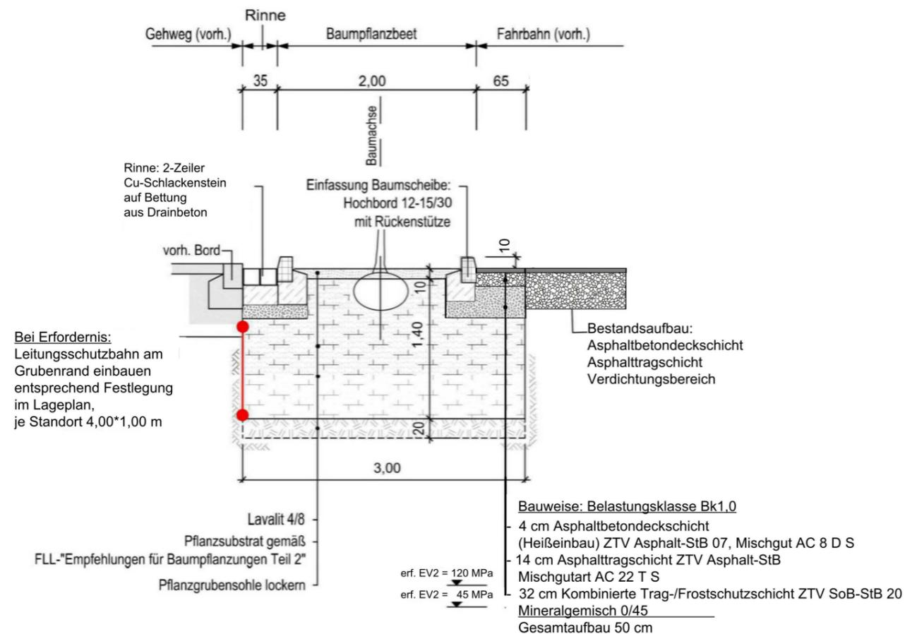
Schnitt bei Asphaltdeckschicht und Pflasterunterbau
